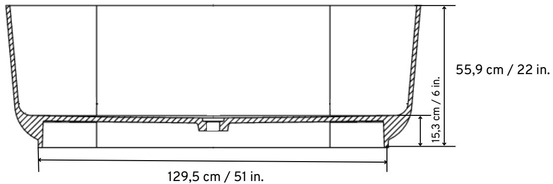
*Le bain Destiny est conçu sans trop-plein et sans possibilité d'y en installer un. Dû à l'absence de trop-plein, ne laissez jamais la baignoire sans surveillance lors de son remplissage pour éviter tous risques de dégât d'eau.*
