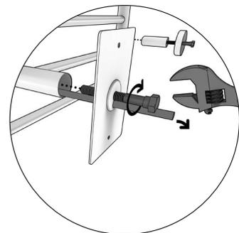
7. Retirez le tube déjà présent sur le chauffe-serviette et le remplacer par le tube disponible dans la boîte prévue pour l'installation sans fil apparent.
