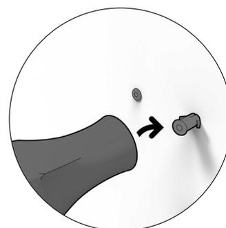
5. Insérez l'ancrage dans les trous.
