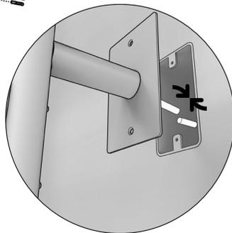
8. Passez le câble d'alimentation dans le tube prévu à cet effet et passez le fil dans la plaque. Rivetez la base sur l'écrou avec la vis de fixation.
