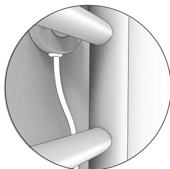
8. Le câble d'approvisionnement doit sortir à l'arrière de l'appareil.
