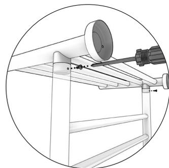
2. Glissez le plateau dans les tubes supérieurs et sécuriser le avec les vis.
