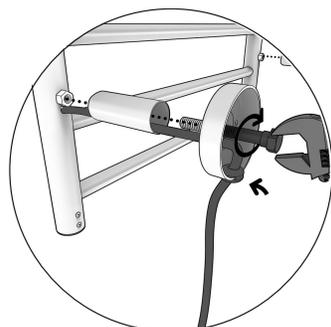
6. Rivetez la base sur l'écrou avec la vis de fixation.
