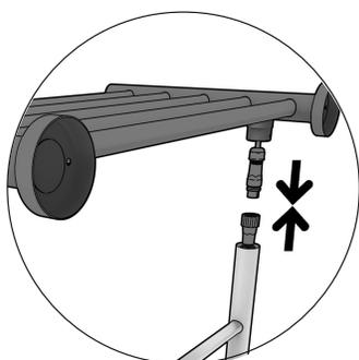
1. Connectez le fil du plateau au fil sortant du tube horizontal supérieur et reliez les tubes du plateau aux tubes horizontal du chauffe-serviettes.
