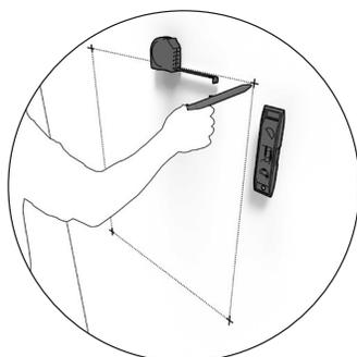
3. Identifiez l'emplacement des trous de vis sur le mur.
