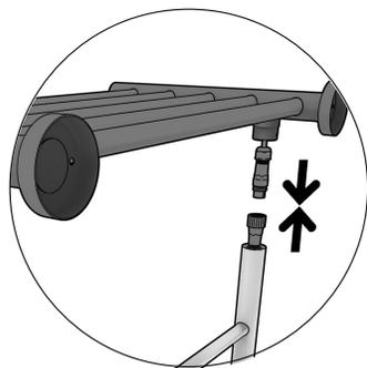
1. Connectez le fil du plateau au fil sortant du tube horizontal supérieur et relier les tubes du plateau aux tubes horizontal du chauffe-serviettes.
