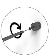
5. Installez les bouchons d'ancrage avec la vis de fixation au mur.
