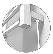
6. Le câble d'approvisionnement doit sortir à l'arrière de l'appareil.
