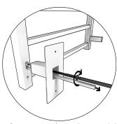
6. Coupez le câble d'approvisionnement. Assurez-vous de garder assez de fil pour le passage dans le tube et pour le branchement dans la boite de jonction. Retirez le tube déjà présent sur le chauffeserviette et le remplacer par le tube disponible dans la boîte prévue pour l'installation sans fil apparent.
