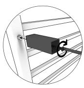
1. Rivetez la base sur l'écrou du produit avec la vis de fixation.
