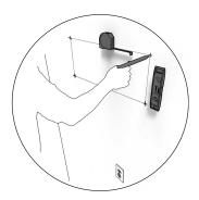
2. Identifiez la distance des supports sur le mur.
