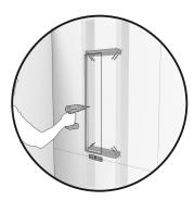
3. Mettre à niveau et fixer le cadre de soutien supérieur et inférieur aux montants verticaux adjacents.
