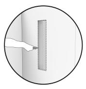
2. Tracer la ligne de coupe au crayon, au-dessus de la ligne médiane, découper une cavité sur le panneau mural le long de la ligne tracée. Assurez-vous que les lignes du haut et du bas sont au niveau.
