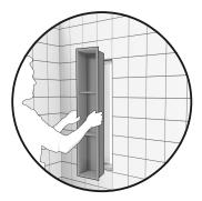
7. Insérer la niche dans la cavité. Appuyer fermement sur la bride et assurez-vous que la niche est bien en place. Il est recommandé de sceller l'espace entre la bride et le carreau.
