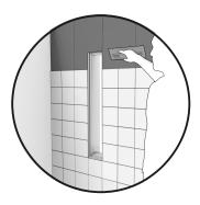
5. Appliquer votre matériel de pose et fixer vos carreaux, marbres ou pierres directement sur le mur de la douche. Il est préférable que les carreaux soient symétrique autour de la structure de support.
