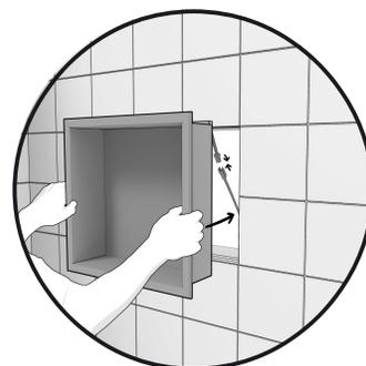
8. Insérer la niche dans la cavité et branchez le connecteur de la niche au connecteur du fil 12 volts. Appuyer fermement sur la bride et assurez vous que la niche est bien en place. Il est recommandé de sceller l'espace entre la bride et le carreau.
