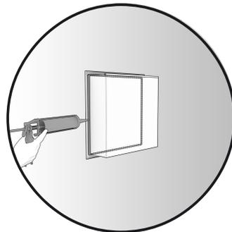
6. Appliquez une couche nécessaire de silicone au pourtour arrière de la bride de la niche afin d'assurer l'étanchéité.
