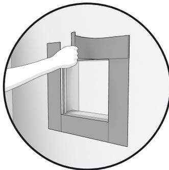
4. Installer une membrane d'étanchéité pour sceller la structure de support et la cavité (non incluse).
