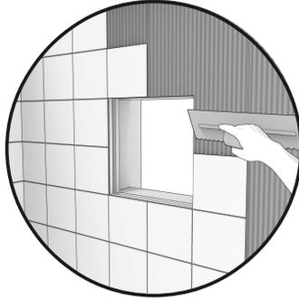
5. Appliquer votre matériel de pose et fixer vos carreaux, marbres ou pierres directement sur le mur de la douche. Il est préférable que les carreaux soient symétrique autour de la structure de support.
