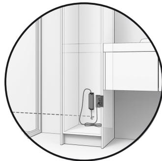
7. Veuillez installer le transformateur fourni afin d'alimenter la lumière de la niche. Le transformateur doit rester accessible donc vous pouvez prévoir un endroit pour le dissimuler.
