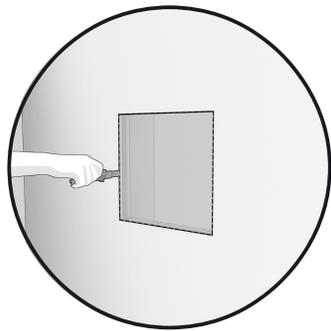
2. Tracer la ligne de coupe au crayon, au-dessus de la ligne médiane, découper une cavité sur le panneau mural le long de la ligne tracée. Assurez-vous que les lignes du haut et du bas sont au niveau.
