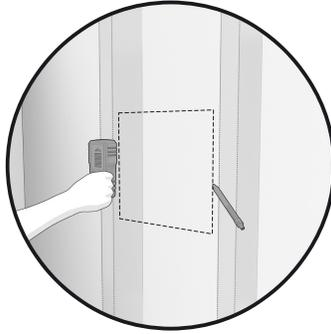
1. Localiser et marquer les lignes centrales des montants adjacents à l'aide d'un détecteur de montants. Tracer une ligne de niveau entre les deux montants du mur à la hauteur souhaitée pour insérer la niche.
