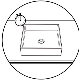
5. Laisser sécher le mastic quelques heures avant de raccorder les tuyaux d'alimentation d'eau et le drain.
