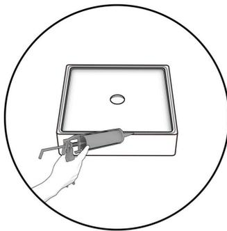
4. Appliquer le mastic de plomberie tout le long du bord intérieur situé sous le lavabo. Déposer le lavabo à l'endroit désiré. Appuyer fermement afin de répandre le mastic et essuyer immédiatement le surplus à l'aide d'un linge humide.
