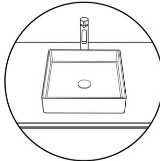
6. Installer le robinet et le drain en suivant les instructions fournies. Serrer délicatement le drain au lavabo afin d'éviter de briser ce dernier.
