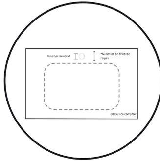
2. Tracer les dimensions des trous à percer dans le comptoir. Mesurer l'espace nécessaire pour l'installation du drain et de la robinetterie.
