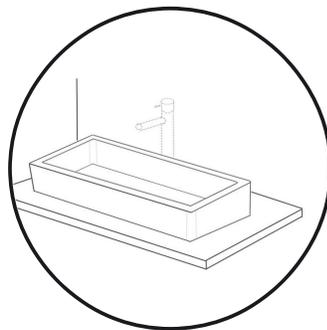
6. Installer le robinet et le drain en suivant les instructions fournies. Serrer délicatement le drain au lavabo afin d'éviter de briser.
