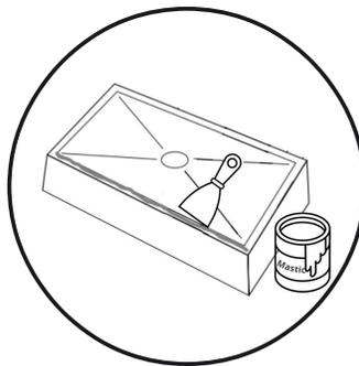
4. Appliquer le mastic de plomberie tout le long du bord intérieur. Déposer le lavabo à l'endroit désiré. Appuyer fermement afin de répandre le mastic et essuyer immédiatement le surplus à l'aide d'un linge humide.
